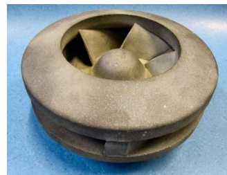
Keramisches Radialpumpenlaufrad (Ø 250 mm).
